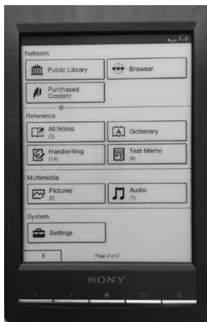
Ilustr. 3. Czytnik e-książek Sony Reader model PRS-T1 z obsługą dotykową na ekranie i przyciskami. Fot. autora
